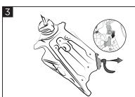
Disconnect the fuel pump cover cable and the fuel connector as indicated in the diagram. Remove the original tank. Sconnettere il cavo alimentazione della pompa. Scollegare connettore benzina. ogliere il serbatoio originale.
