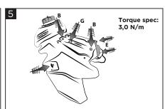
Place the Acerbis fuel tank (A) on the bike. Insert the tank (G), seat (B) and radiator scoops screws as indicated in the diagram. Montare il serbatoio Acerbis sulla moto. Riavvitare la vite (G), Riavvitare le viti (B) della sella e degli spoiler.
